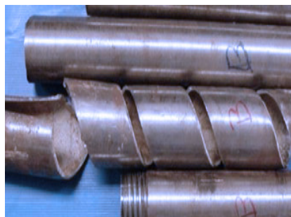
FATIGA – EN ESPIRAL DEBIDO AL TORQUE
